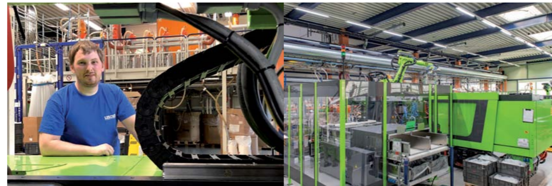
Stefan im Glück. Die 36 Tonnen schwere Kunststoffspritzgussmaschine des österreichischen Herstellers Engel ist gut im 1. Stock gelandet.
